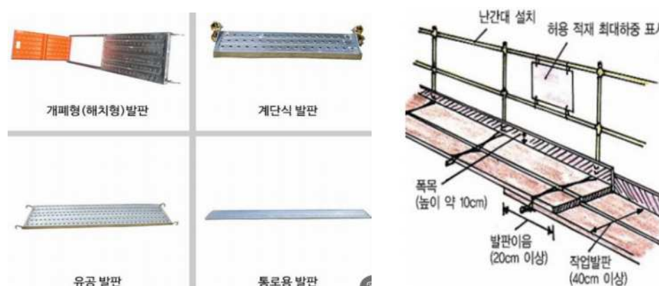
[그림 4-4] 발판의 종류 및 발판 설치의 예
